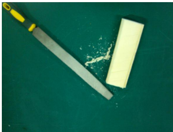
图 2-7 聚氨酯泡沫打磨
