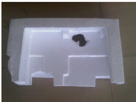
图 2-4 硅油腐蚀聚苯乙烯
