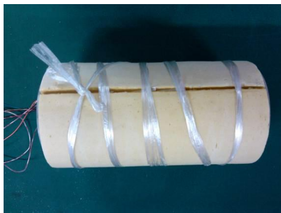
图 5-3 柱面聚氨酯泡沫保温层
