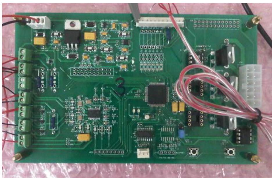
图 4-6 恒温控制电路板实物图
